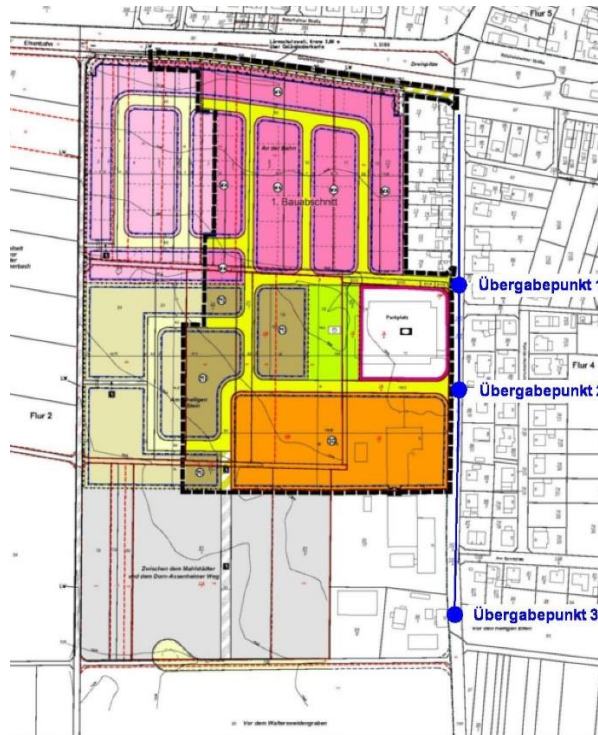
Abb. 7 Übergabepunkte Bestand / Erschließungsgebiet
